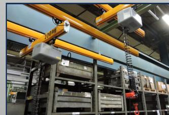
Flächenkrananlage mit Stahlprofil und e-Motion Seilbalancer
